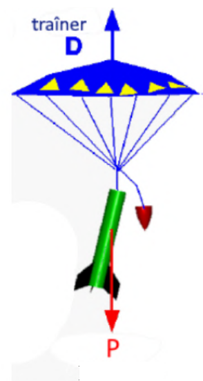
Figure 11 : Équation de la force de traînée et obtention de la vitesse du parachute en régime permanent.
